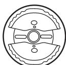
Горизонтальная плоская струя – Наносится на поверхность движением вверх-вниз.
